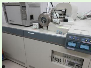
高分解能二重束束質量分析計 JEOL MS700 受託測定しています
